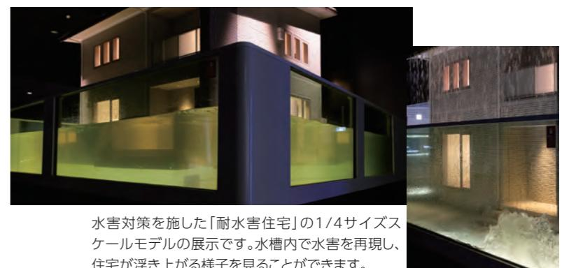
水害対策を施した「耐水害住宅」の1/4サイズスケールモデルの展示です。水槽内で水害を再現し、住宅が浮き上がる様子を見ることができます。
